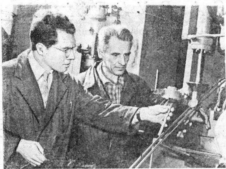
Москва. Через шесть секунд — деталь — такова производительность первой в стране кузнечно-роторной линии для производства заготовок клапанов двигателей внутреннего горения. Эта оригинальная машина создана в научно-исследовательском институте технологии тракторного и сельскохозяйственного машиностроения. На новой линии детали изготавливаются из жаростойких сталей, что резко удлиняет межремонтный срок работы тракторов и других машин.
