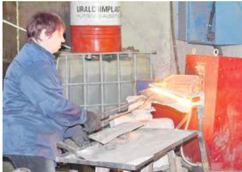
Идёт наплавка режущей кромки на лемех.
